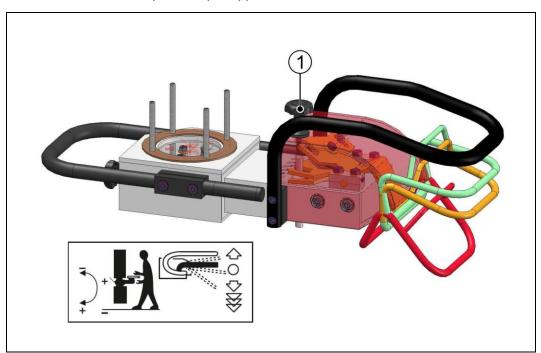
Le réglage de la hauteur de la machine de levage par ventouse avec la charge s'effectue au moyen de la vis de réglage (1) située sur la face avant de l'unité de commande.
