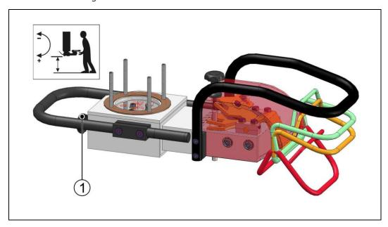
La quantité d'air parasite peut être réglée en tournant la vis de réglage (1) au dos de l'unité de commande.
